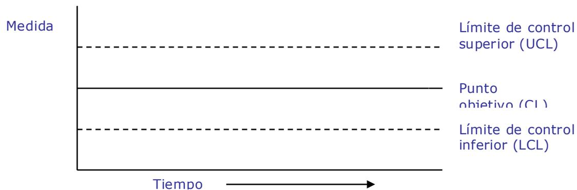
En la gráfica de control, el eje horizontal enumera las muestras o los puntos en el tiempo. El eje vertical contiene las medidas de estas muestras. La línea del control (CL, Control Line) denota el punto objetivo del proceso. Los límites de control aceptables superiores y más bajos son representados por líneas: Límite de Control Superior (UCL, Upper Control Limit) y Límite de Control Inferior (LCL, Lower Control Limit).
